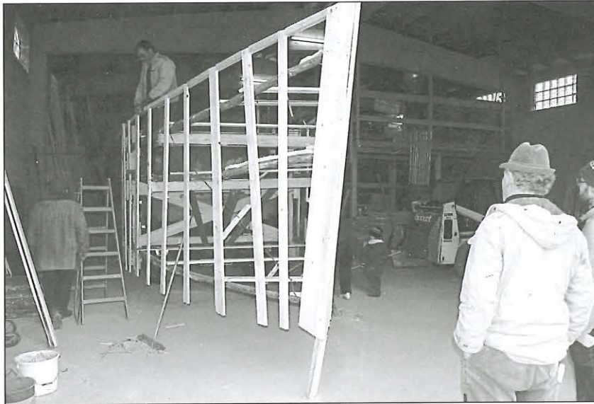
Begutachtung und Ausrichtung des gesamten Bootsrumpfes.
